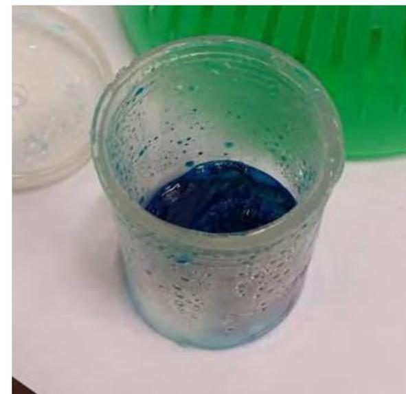
**Εικόνα 2:** Η εικόνα δείχνει το δείγμα ελέγχου μετά από 12.500 κύκλους υψηλής πίεσης χρήσης του ουρητηρίου με καζανάκι.
